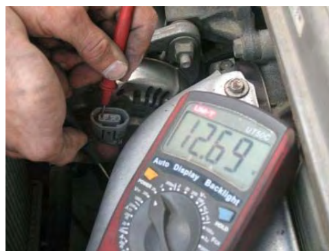
При необходимости замеряем напряжение на выводе S
