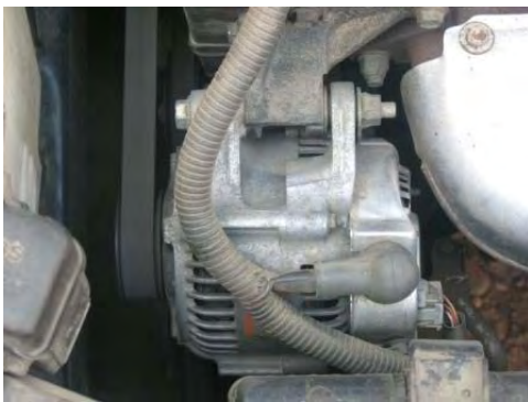
Общий вид генератора на автомобиле
