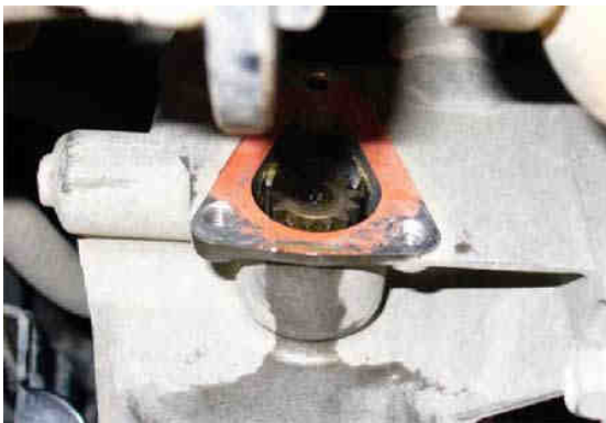
Фото 6 (справа): Крайнее левое положение штока соответствует положению режима 2 WD
