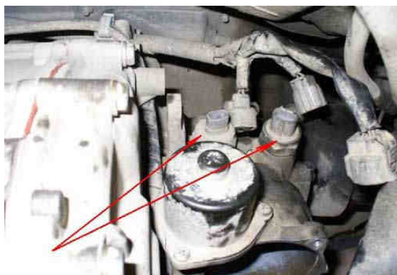
Фото 7(слева): Датчики контроля положения штока. При положении режима «2WD» контакты датчиков разомкнуты. При положении режима «4WD» (межосевой дифференциал заблокирован) контакты датчиков замкнуты.
